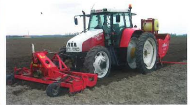
▲ Voer pootbedbereiding en potten bij voorkeur in één werkgang uit om bodemverdichting onder de rug te vermijden. Op lichte zavelgronden kan soms ook meteen de rugopbouw worden meegenomen. De pootbedbereiding gebeurt in het algemeen met aangedreven werktuigen als de rotorkoepel en de volveldsfrees.
