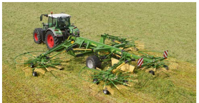
Swadro 1400 en 1400 Plus, getrokken harken met vier elementen en middenafleg. Variabele werkbreedtes van 11,00 m t/m 13,50 m
