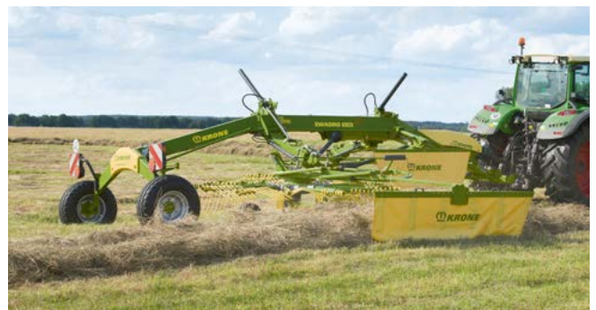
Swadro TS en TS Twin, getrokken harken met twee elementen en zijafleg Werkbreedtes van 6,20 m t/m 8,20 m
