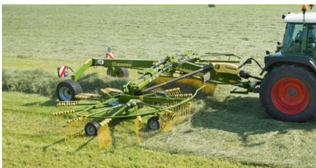
Swadro TC en TC Plus, getrokken harken met twee elementen en middenafleg. Variabele werkbreedtes van 5,70 m t/m 10,00 m
