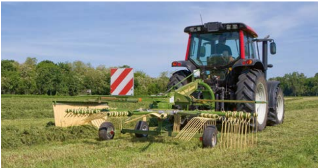
Enkele Swadro harken voor in de driepuntshef Werkbreedtes van 3,50 m t/m 4,60 m
