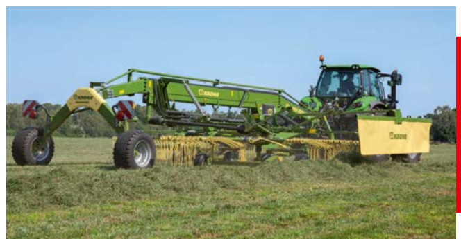
Swadro TS 970, getrokken hark met drie elementen en zijafleg Werkbreedte 9,70 m
