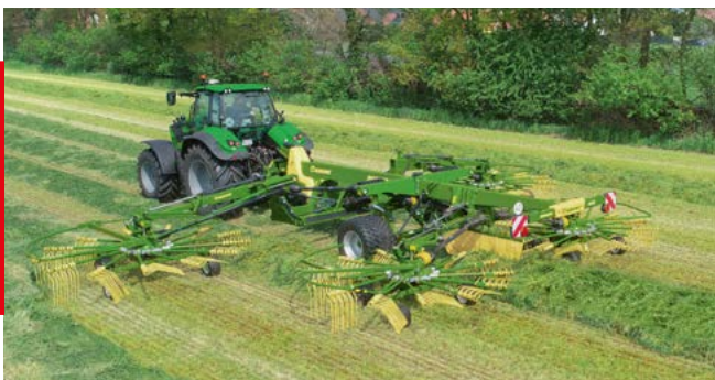
Swadro TC 1370, getrokken hark met vier elementen en middenafleg Variabele werkbreedtes van 10,80 m t/m 13,70 m
