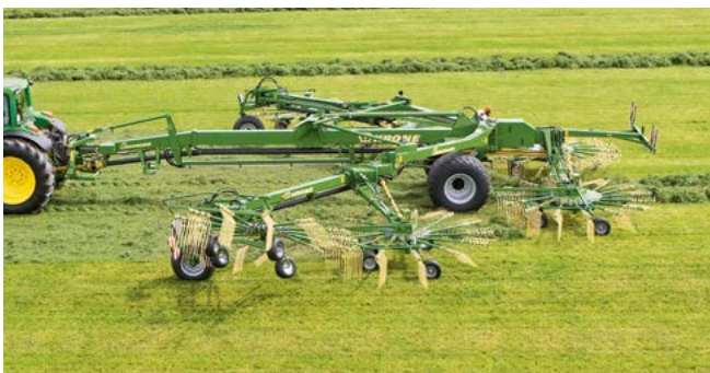
Swadro 2000, getrokken hark met zes elementen en middenafleg Variabele werkbreedtes van 11,00 m t/m 19,00 m
