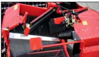
Type NB met 3e egelband en 3e afstrijkrol – voor nog meer capaciteit op lichte grondsoorten
