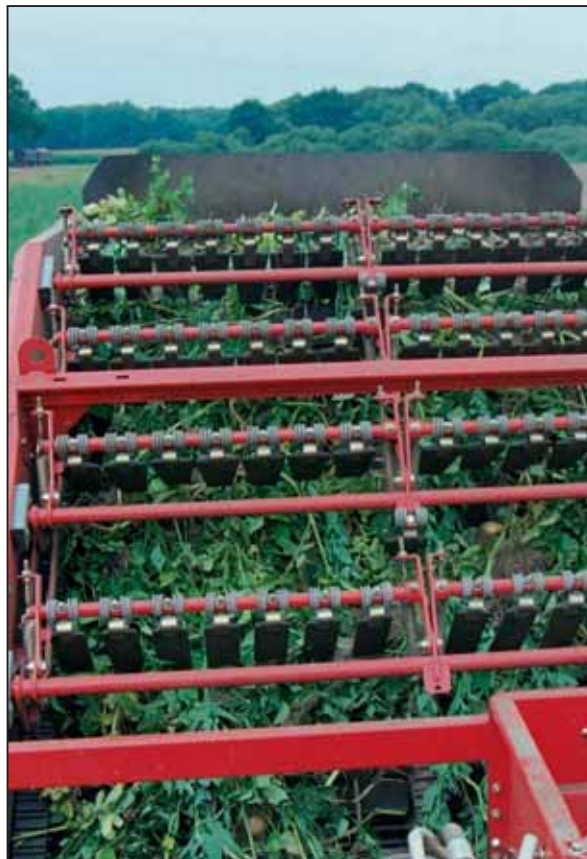
Optimale productvriendelijkheid: loofband met zachte PU-meenemers (afstand 200 mm of 280 mm)
