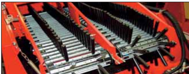
Type UB: perfecte reinigingsresultaten van grondsoorten met veel kluiten en weinig stenen
