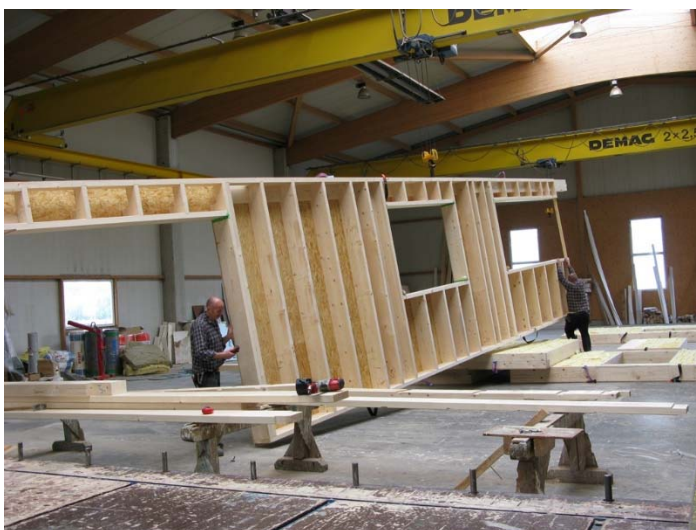
Figuur 1. Prefab wanden worden in de timmerfabriek gemaakt.
