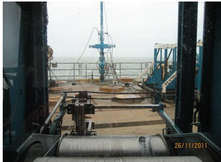
Blik vanuit controle unit naar de BOP en lubricator
