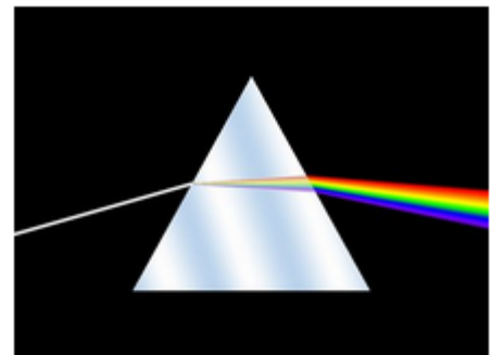
Met een prisma of tralie is die straling uiteen te rafelen tot een spectrum.
