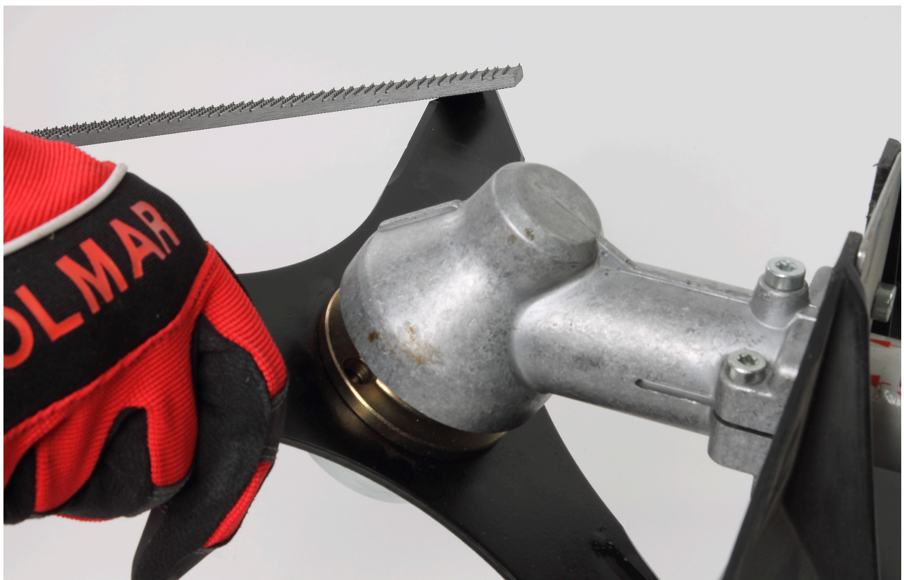
Afbeelding 17. De juiste vijlmethode: met de fijne kant
