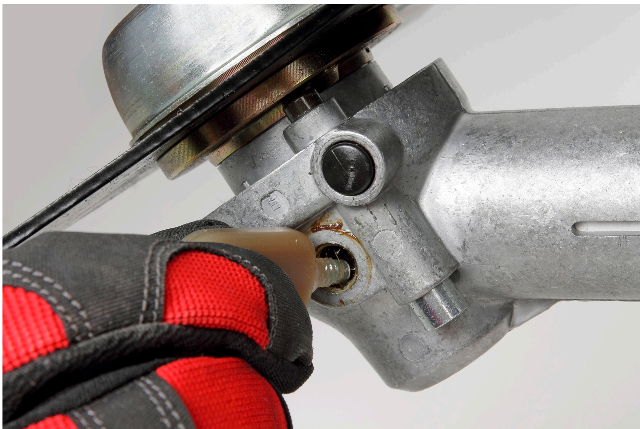
Afbeelding 9: Vullen van de bosmaaier met speciaal vet
