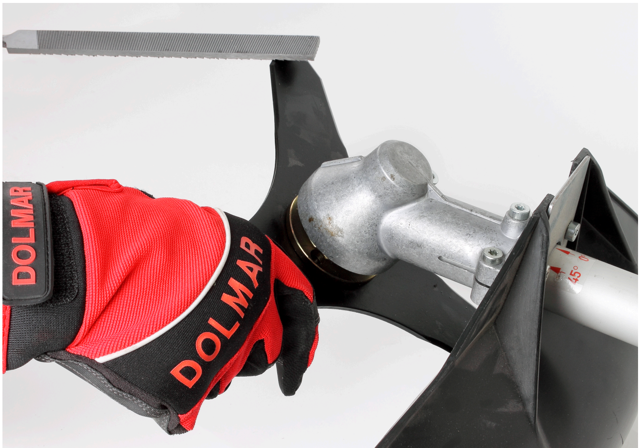
Afbeelding 16. Fout: Slijpen van de messen met de grove kant
