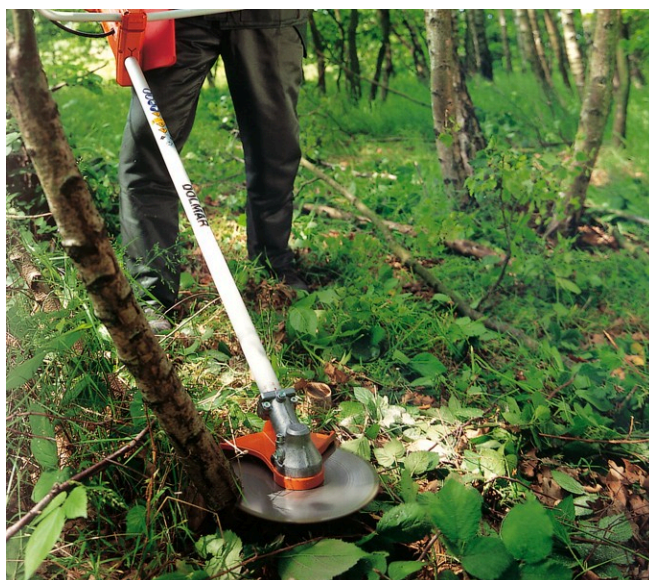
Bosmaaier met zaagblad en speciale beschermkap
