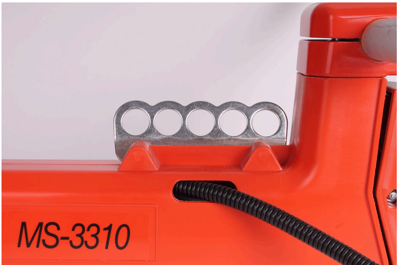
Afbeelding 6: De ophangstrip van een bosmaaier
