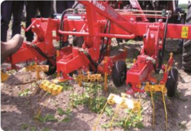
Afb. 1 Deze machine bestrijdt onkruiden door vingerwielers, schoffelmessen en egjes die door de rij trekken.
