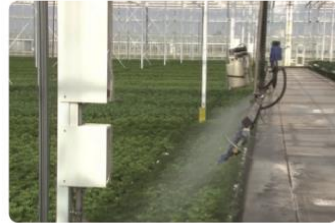
Afb. 4 Het uitvoeren van een chemische gewasbescherming met behulp van de spulrobot is een veilige manier van toedienen in de beschermde teelten.
