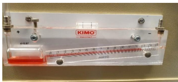
Figuur 4 Drukverschil in de hellende-baan manometer
