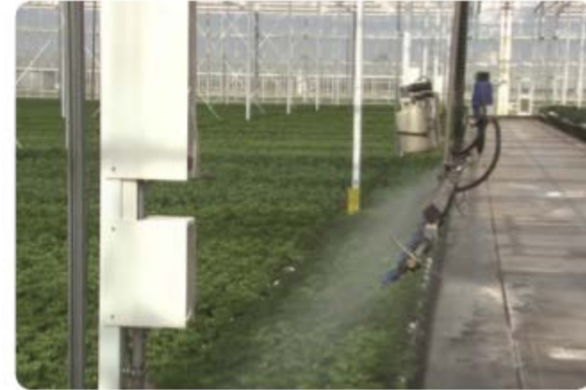
Afb. 4 Het uitvoeren van een chemische gewasbescherming met behulp van de spulrobot is een veilige manier van toediening in de beschermde teelten.
