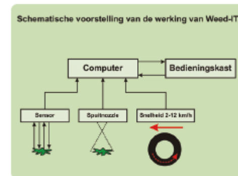
Afb. 15 Werking van de Weed-IT. Een sensor op een van de wielen meet de snelheid van het voertuig. De computer regelt elke sensorspuitopcombinatie afzonderlijk.
