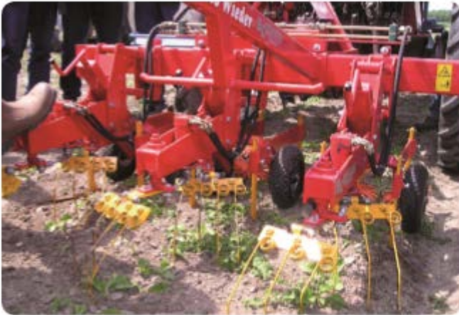
Afb. 1 Deze machine bestrijdt onkruiden door vingerwielers, schoffelmessen en egjes die door de rij trekken.
