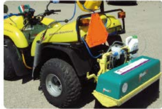
Afb. 13 Door het gebruik van een schijfvernevelaar en van sensortechnieken is het gebruik van bestrijdingsmiddel zeer beperkt.
