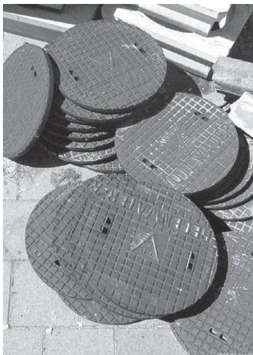
Figuur 6.18 Voorbeelden gedeelte van rioolputafdekking en rioolputdeksels met opschrift "regenwater" [Betonplaza]
