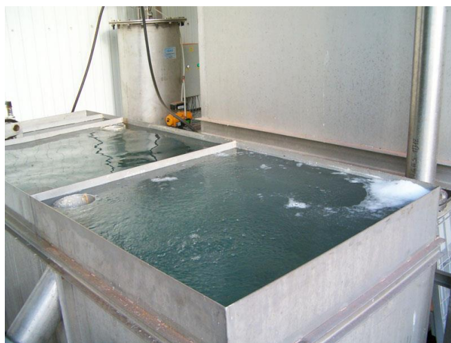
Figuur 36: flotatietank. Te zien is het door flotatie gevormde schuim en de schuimafvoerbuis, die aan het wateroppervlak is gesitueerd.
