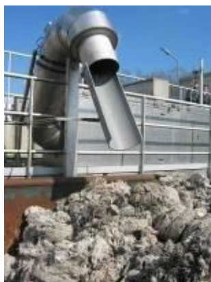
Figuur 20: de geperste drab uit rioolwater: voor een groot deel bestaand uit toiletpapier.
