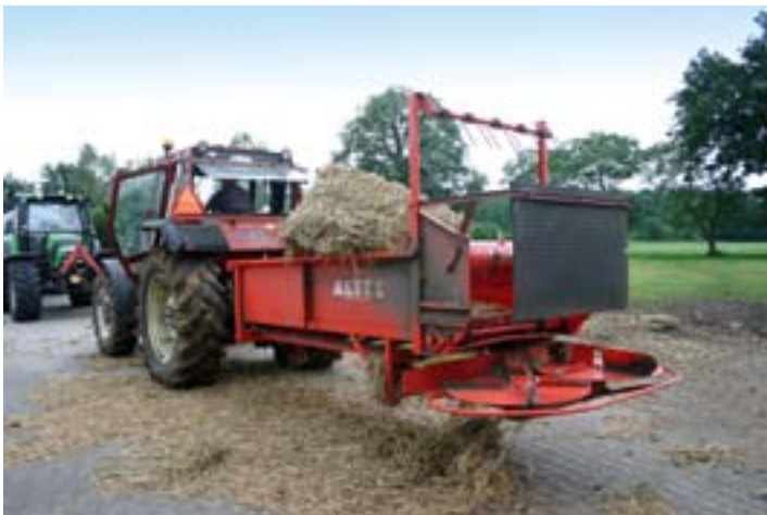
▲ Deze machine is geschikt om stro over het land te verspreiden. Op die manier kun je stro mengen met najaarsgras, waardoor je een goed te conserveren kuil kunt maken.
