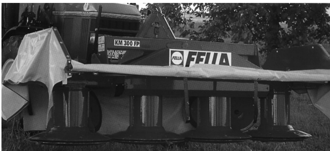
Fig. 8.7 Een trommelmaaier.
