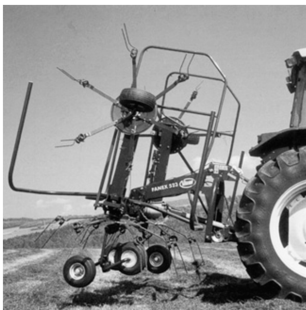
Fig. 9.3 Een aanbouwcirkelschudder met vier schudelementen.
