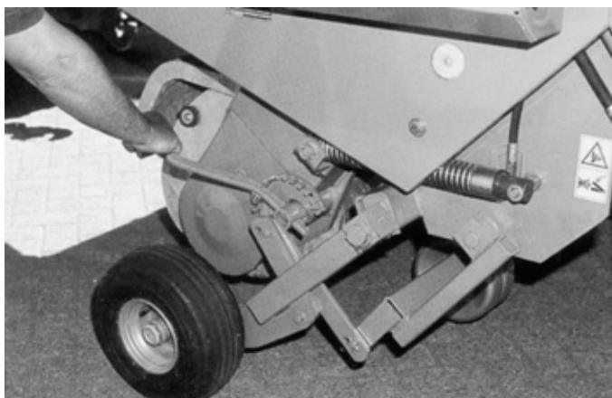
Fig. 10.9 Met de hand de tanddiepte instellen.
