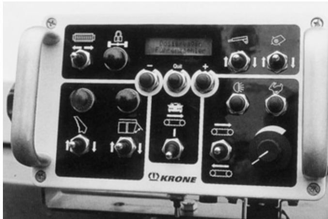
Fig. 10.11 De elektronische comfortbediening.
