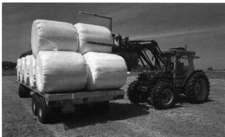
Fig. 10.29 Met een voorlader (met daaraan een balenklem) worden de pakken van de oprolpers op de wagen gezet.
