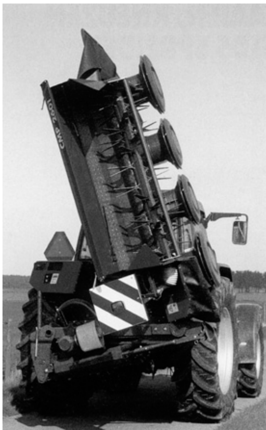
Fig. 8.25 Achtermaaier in opgeklapte stand.
