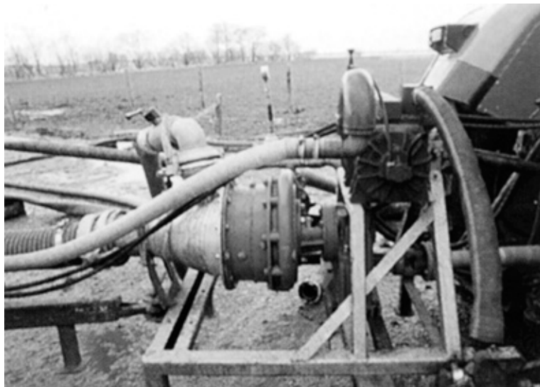
Fig. 11.35 Een centrifugaalpomp pompt mest naar de bemester.
