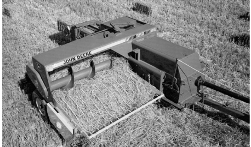
Fig. 10.17 De kleine pakkenpers of opraappers wordt gebruikt voor het persen van hooi en stro.
