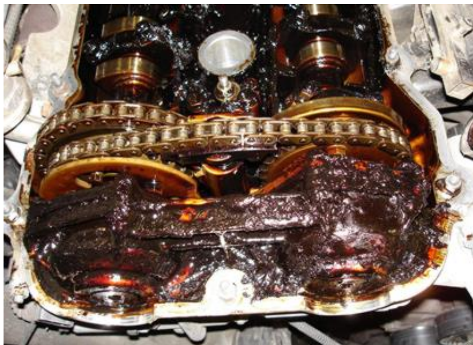
Olie sludge aan de binnenkant van een BMW-motor Olie sludge is het product wat overblijft van overbelaste olie in een motor.
