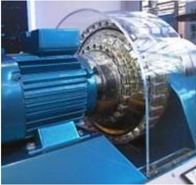
Vloeistofkoppeling
