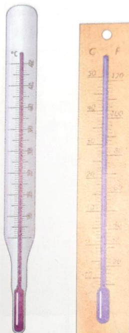
◀ figuur 30 een koortsthermometer en een buitenthermometer
