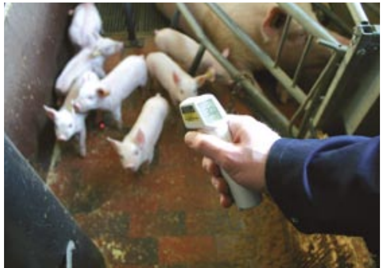
Een infraroodthermometer meet de temperatuur op de plaats waar het rode licht valt. Zo kun je in een controleonde snel zekerstellen dat de temperatuur van de vloer klopt. Een goedkoop en nuttig hulpmiddel.
