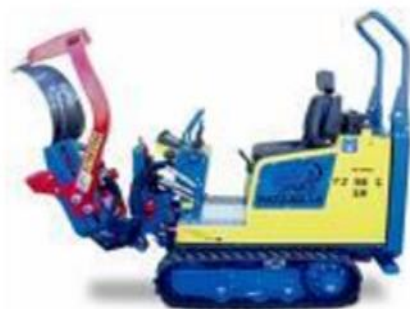
Figuur 1.3 Met de kluitenrooimachine worden draadkluiten gemaakt, die een bescherming bieden voor de wortels.
