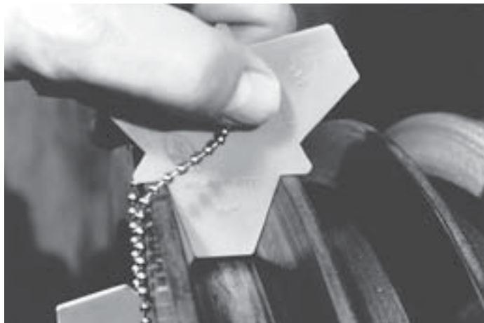
Gates-groefmallen vergemakkelijken het opsporen van slijtage.
