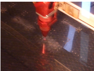
De lasersnijder aan het werk met Lab on a chip uitsnijden
